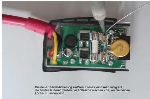
Die neue rückstellende Sicherung am einfachsten außen auf den Laschen auflöten. Achtet dabei darauf, dass die Drähte des Bauteils nicht irgendwo an anderen Teilen des Einsatzes/Cardridge anliegen, außer auf der dazu vorgesehenen Lasche! Zum Vergrößern auf das Bild klicken.
